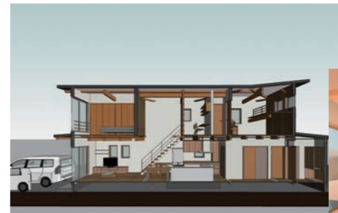
BIMモデルの断面パース。建築については素人の施主と建築士が、完成後のイメージを容易に共有できることが BIMの最大のメリットである
