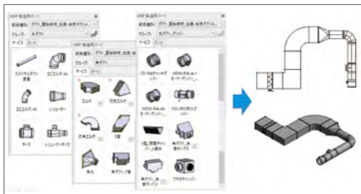
フカガワが作成中の Item を使い Revit で製造用パーツとしてモデリングしたダクト
