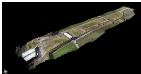
盛り土前の現場モデル(左)。黄色や赤色の部分が盛り土した部分。盛り土前のモデルと比較すると土量が得られる(右)
