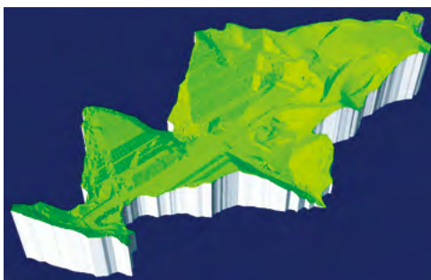
切り土現場を 3D スキャナーで計測した結果を 3D モデル化したもの(左)。さらに現場の写真を張り付けたもの(右)
