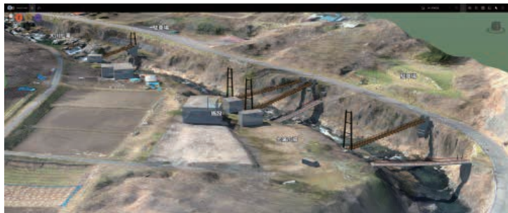
渓谷の様々な場所に橋のモデルを架けて景観シミュレーションや動線の検討を行った
