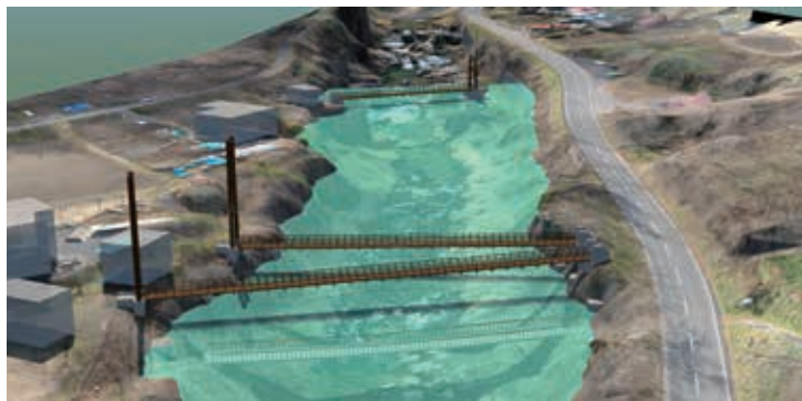
CIMモデル上で再現した洪水時の水位。一般の人にも橋がどうなるのかが一目瞭然だ
