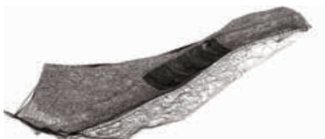
AutoCAD Civil 3D に点群データを読み込み、各点間に三角形の面を張ったTINデータ
