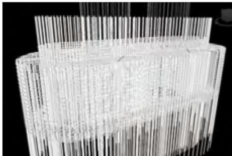
新石狩大橋の橋脚工事で使う仮橋の CIM (Civil3D) モデル(上)と
