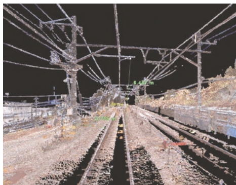
点群と3次元モデルを統合し、走行シミュレーションを行う
