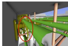
上部工鉄筋（橋軸方向）と床版横 締め補強筋が干渉 →【対応方針】図面への注記を追加 （ずらして配置が可能）
