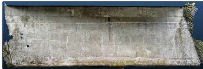
iPad ProのLiDARセンサーで計測したコンクリート構造物の点群データ
