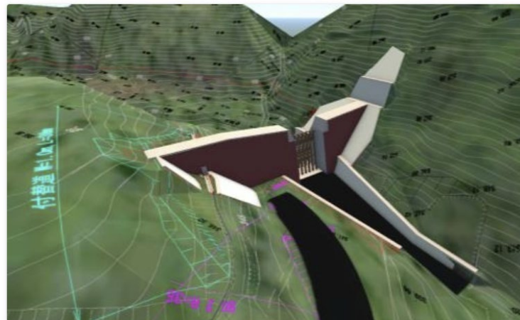
Revitで作成した砂防ダム の BIM/CIMモデル。今後、堆積する土砂量を求めるため、iPad ProのLIDAR機能で計測した点群データをCivil 3Dに読み込み、高精度で算出する
