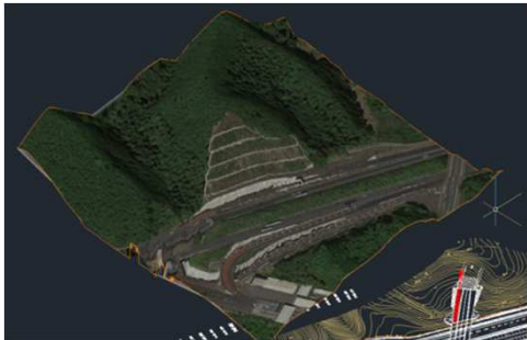
崩壊前の3次元地形モデル
