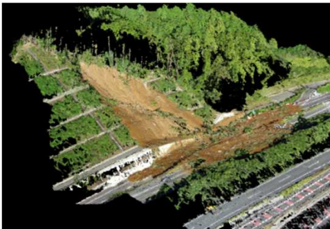
崩壊箇所の3次元地形モデル
