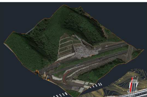
差分による崩壊土量の算出
