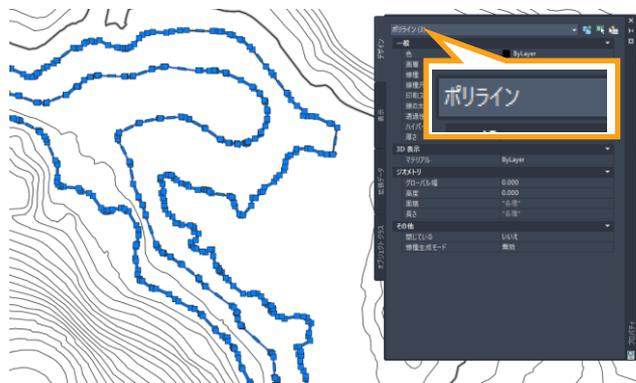
図面クリーンアップでポリラインに変換
