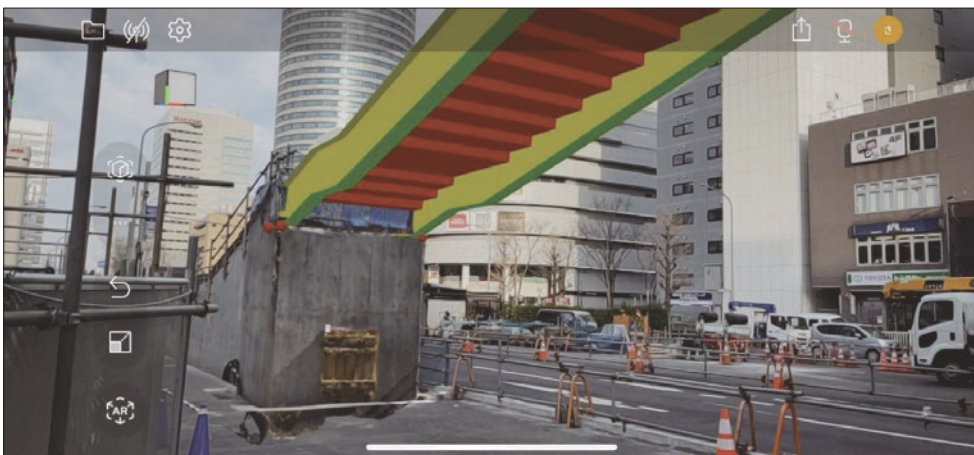
MR 化した BIM モデルや点群データを現場に重ねて、施工確認
