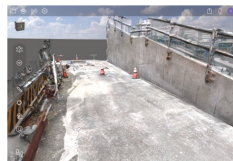
スマホのLiDARで計測した現場の点群データをもとに作成したVR
