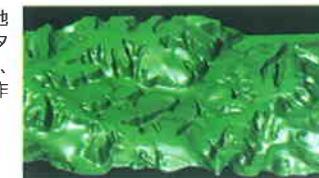
左記の図から、盛り土区域だけを抽出して三次元表示した。谷埋め盛り土の形状がよくわかる
