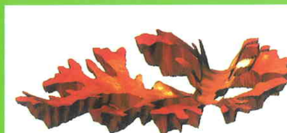
左記の図から、盛り土区域だけを抽出して三次元表示した。谷埋め盛り土の形状がよくわかる
