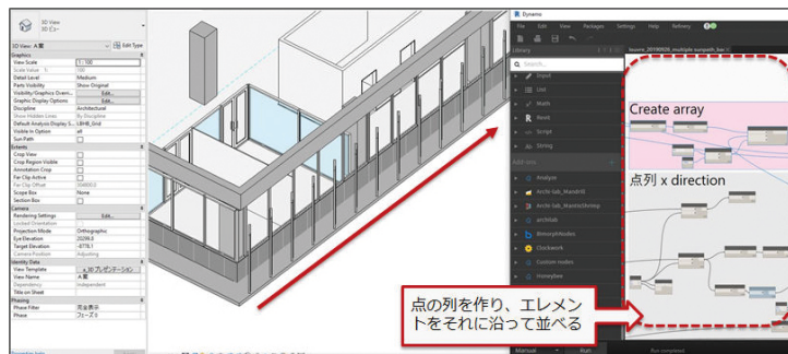
ルーパーのファミリーを一定間隔でBIMモデル上に複写する
