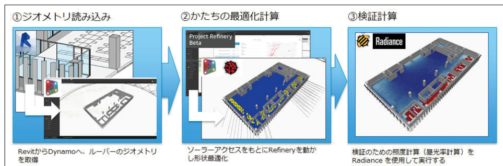
Revitで設計したルーバーの角度やピッチを最適化する作業の流れ
