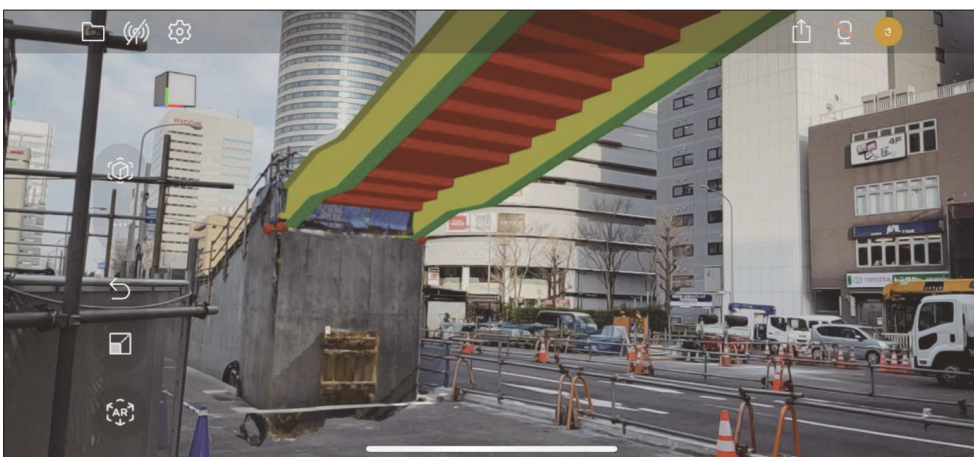
MR 化した BIM モデルや点群データを現場に重ねて、施工確認
