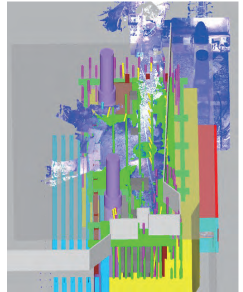
現場付近の CIM モデル。正確な位置がわからなかった電力トンネルは3Dレーザースキャナーで計測した点群データを取り込んだ
