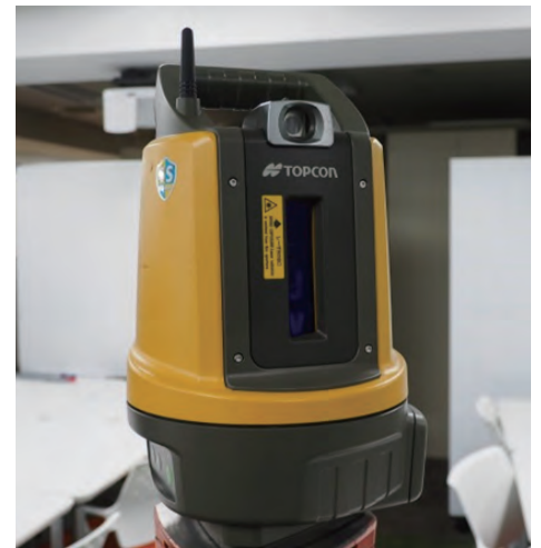
電源を入れると自動的に鉛直軸の方向を調整する機能を搭載した「LN-100」
